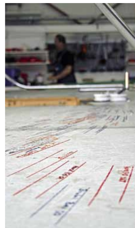
Serietillverkade båtar, till exempel Bavaria och Hanse, har redan färdiga mått för kapellbågar ovanpå tillverkningsbordet.
