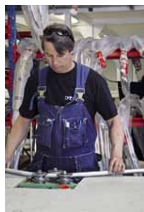
Bågarna bockas i bilen eller uppe i verkstaden. De tillverkas antingen i aluminium eller rostfritt.
