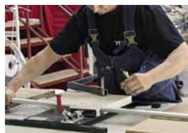
Bågarna bockas i bilen eller uppe i verkstaden. De tillverkas antingen i aluminium eller rostfritt.
